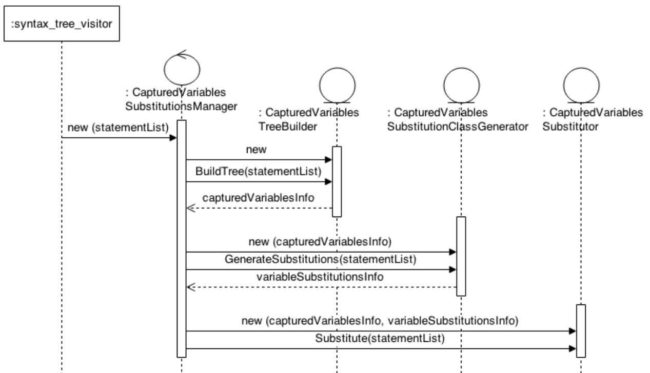
Рис. 7. Стадии семантического анализа лямбда-выражений при обработке замыканий
